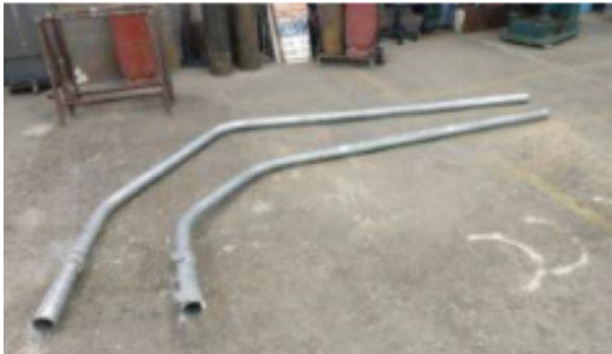
Figura 49: Suporte recuperado P57 para sinalização vertical
