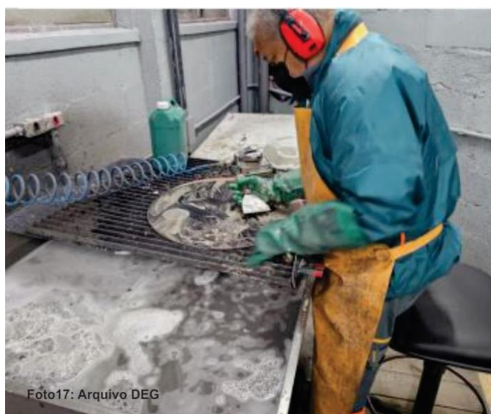
Figura 17: Raspagem das placas
