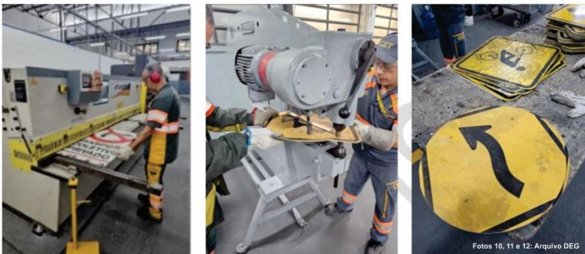
Figura 10: Guilhotina - cortes de chapas / Figura 11: Corte com a Tesoura / Figura 12: Placa originalmente quadrada.
