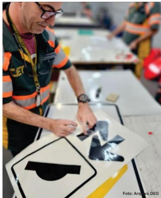
Figuras 27 e 28: Processo de depilação de película
