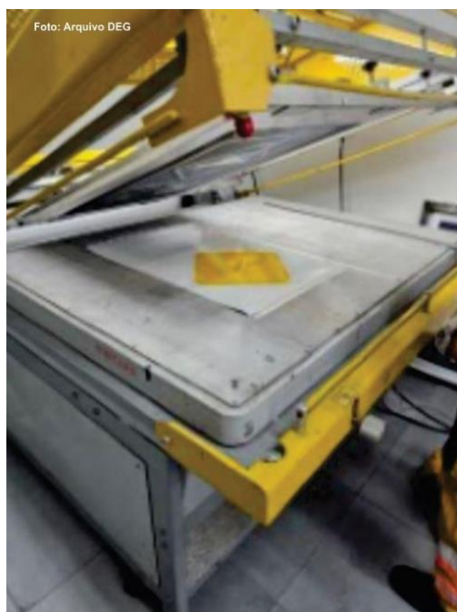
Figuras 29 e 30: Processo de impressão do pictograma sobre a película por silscreen
