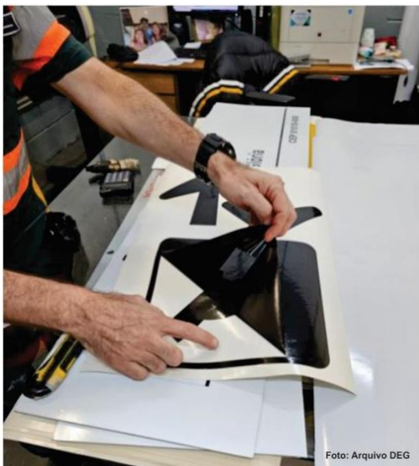
Figuras 27 e 28: Processo de depilação de película
