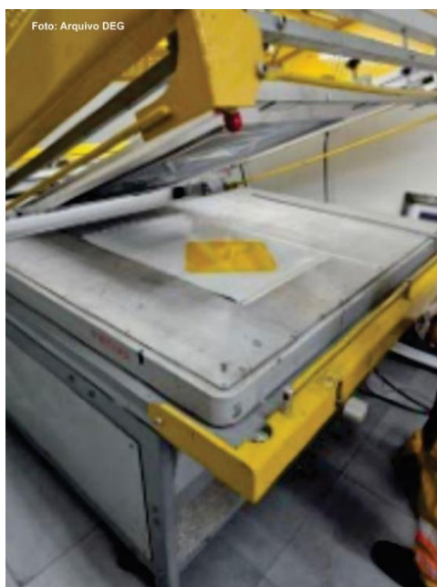
Figuras 29 e 30: Processo de impressão do pictograma sobre a película por silkscreen
