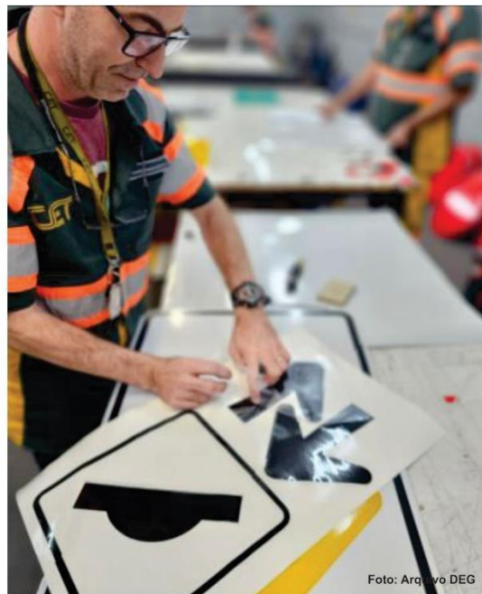
Figuras 27 e 28: Processo de depilação de película
