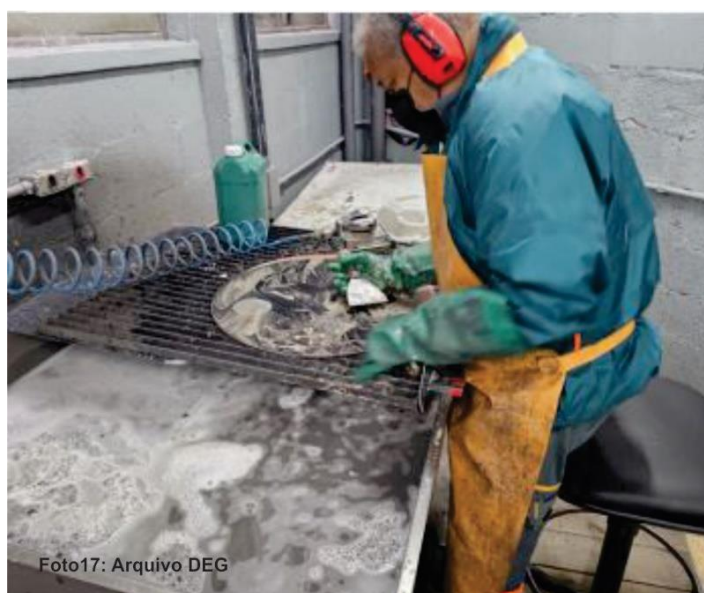
Figura 17: Raspagem das placas
