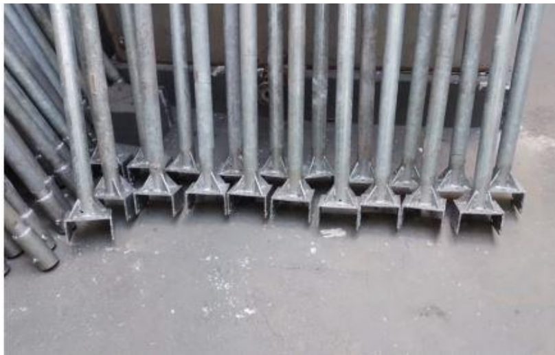
Figura 3: Suporte de placas para fixação em mureta e barreiras de concreto ("New Jersey") - Foto: Arquivo DEG
