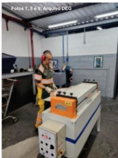
Figuras 7, 8 e 9: Endireitamento de placas através da “Calandra”
