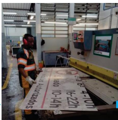
2. Corte da chapa recuperada
