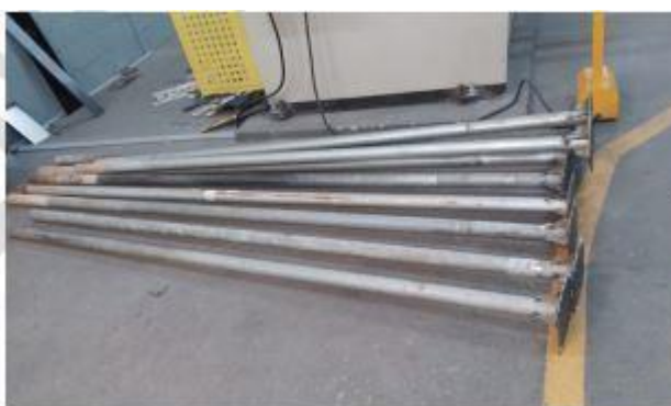
Figura 1: Suporte para placas com base quadrada “PP” para fixação em pontes, viadutos e bases de concreto onde a perfuração não é possível.
