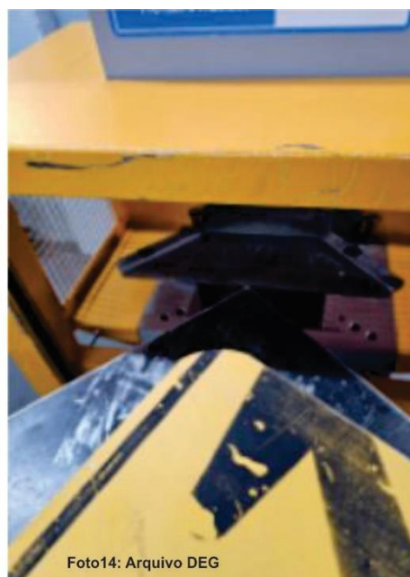
Figura 14: Corte dos cantos arredondados
